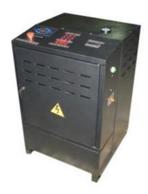
Пароперегреватель электрический марки ПП предназначен для перегрева пара выше температуры насыщения (до 250 °C) с давлением выше атмосферного за счет теплоты, выделяющейся в результате использования электроэнергии. Перегретый пар используется для повышения КПД паровой установки, а также транспортировки по паропроводам без потери теплосодержания.
